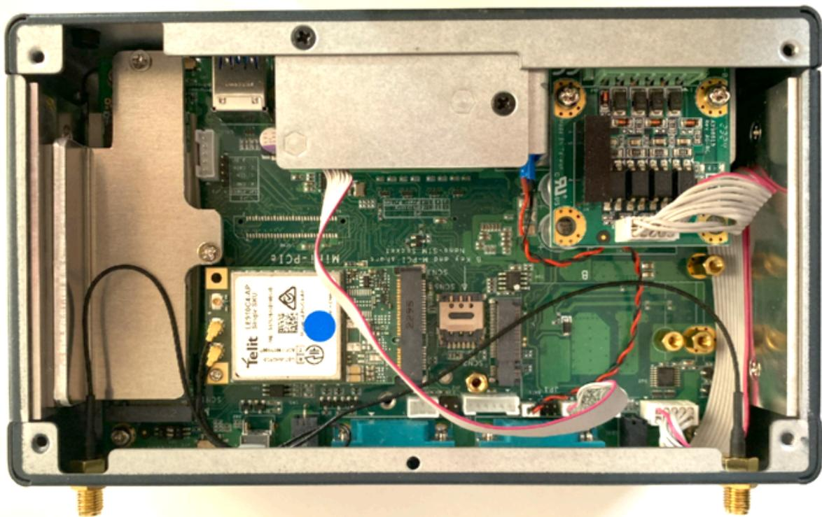
開けたのち、奥にARMMボードが確認できます。また、中央やや右にピアノSWが見えます。SW1をON（下）にして終了です。裏蓋を戻し、電源を入れるとARMMボードが動作します。
