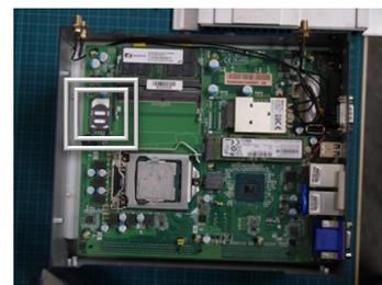
なお、取り外したヒートシンク部に着いている黄色の物体はヒートシンクパッドでデバイスの熱をヒートシンク部逃がすものですので取らないでください。また、CPU の部分にはヒートシンク用グリースが塗ってありますので、これも取らないでください。また、少なければ市販のもので結構ですので足してください。
